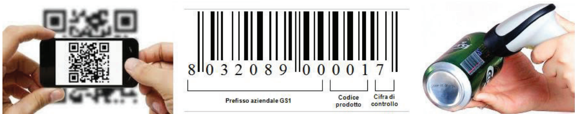
Figure 0-1: Nell'ordine da sinistra verso destra abbiamo un esempio di scansione di un codice a barra tridimensionale mediante un comune smartphone, la struttura di un classico codice a barra che identifica un prodotto in commercio e in fine un esempio di scansione di un codice a barra presente sulla lattina di birra.
